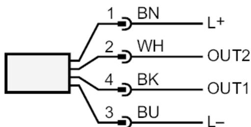
OUT1: Analogausgang Temperaturüberwachung
