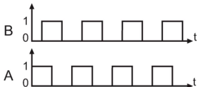
Phasenverschiebung  $90^\circ \pm 20^\circ$
