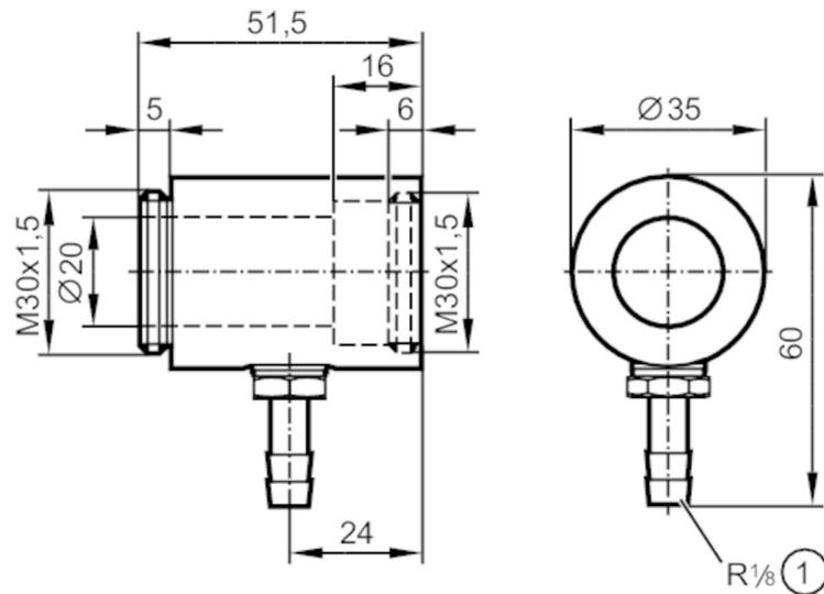
1 Schlauchtülle für Schlauch mit lichter Weite 8-9 mm
