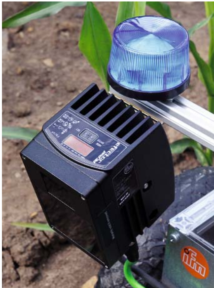
Elektronisches Auge: Der efector pmd 3d erzeugt ein dreidimensionales Umgebungsbild.
