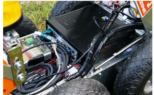
Zentrale Steuerung: Ein leistungsstarker Windows-PC als „Gehirn“ des Feldroboters.
