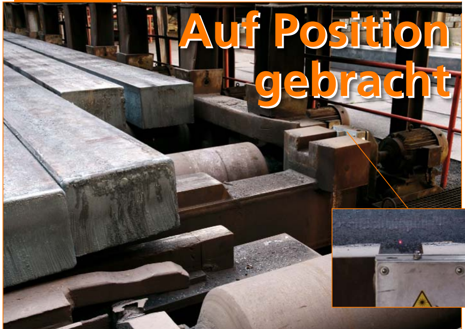
Laser-Abstandssensor efector pmd detektiert die Position von Stahlblöcken.
