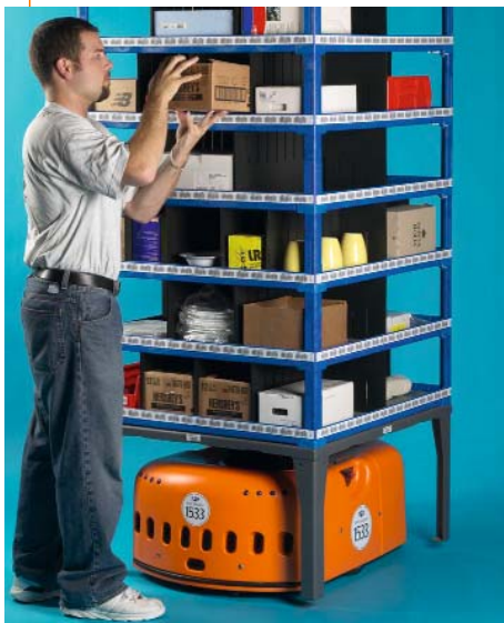
Regalstellage mit Fahrroboter
