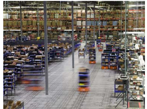
Selbständig fahrende Regale im Versandlager
