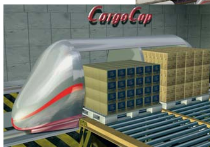
La capsula di trasporto aerodinamica durante il caricamento di due pallet.
