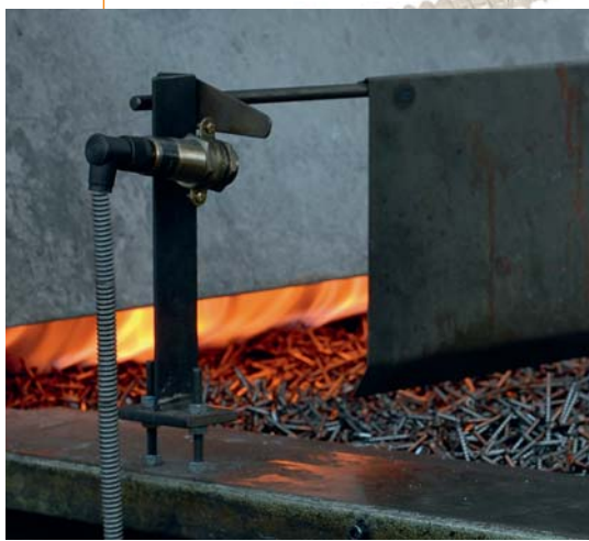
Il sensore induttivo ifm del tipo II0283 controlla, tramite una leva meccanica, la posizione della piastra di distribuzione sul nastro trasportatore per la produzione di viti SPAX.
