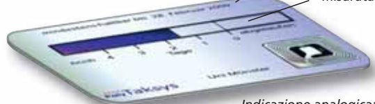
Indicazione analogica: la lunghezza della barra indica il grado di freschezza.
