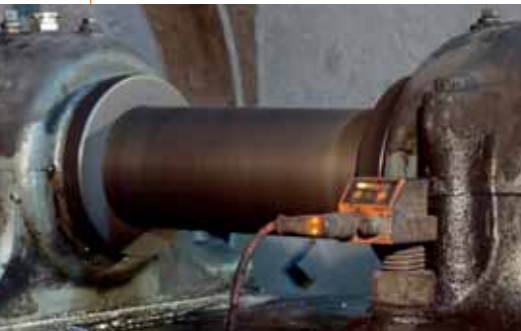
Il sensore efector octavis, controlla il cuscinetto del ventilatore di un forno.
