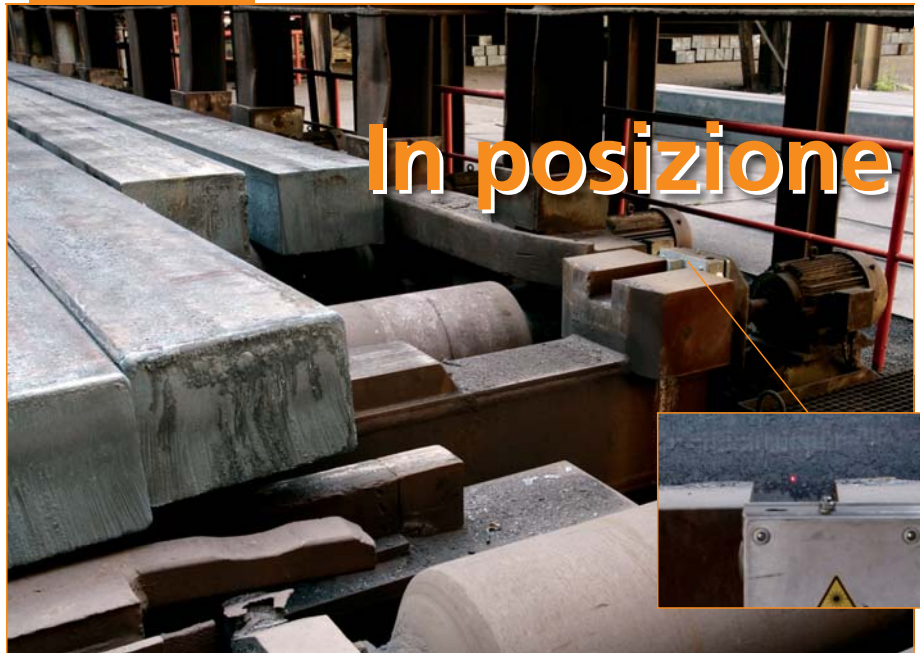
Il sensore laser della distanza, efector pmd, rileva la posizione dei lingotti di acciaio.
