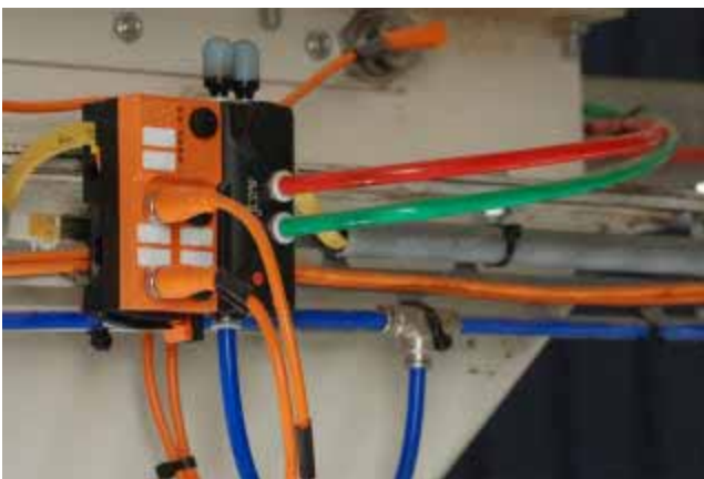
Bild: AS-i AirBox: Pneumatik und AS-i; eine pfiffige Lösung!
