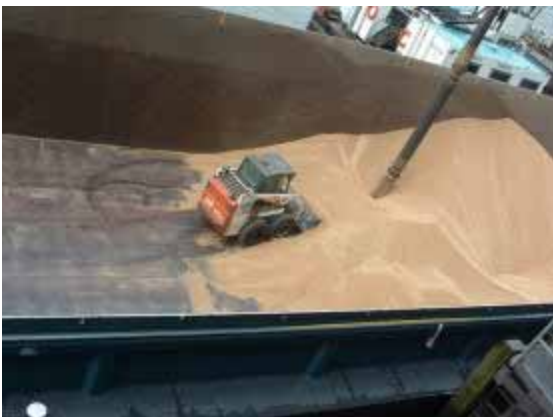
Bild: Entladung des Schiffs mittels Saugrohr
