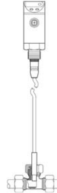
Abbildung 40: Prozeßanschluß über T-Stück Abbildung 40 zeigt den Prozeßanschluß des kompakten Kabelsensors mittels eines T-Stücks.
