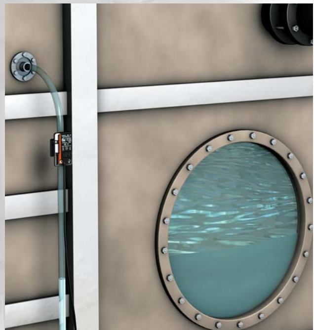
Détection de liquides sur un tuyau de dérivation.
