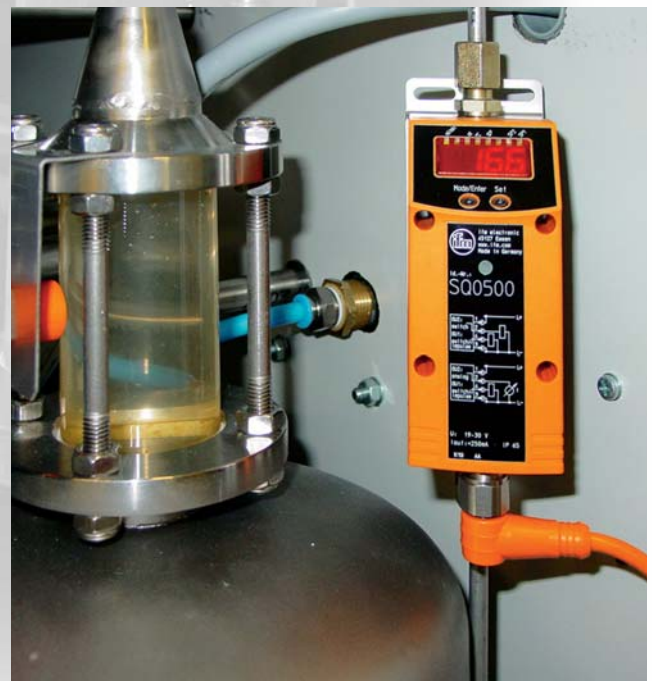
Capteur pour la mesure de quantités de dosage très faibles.
